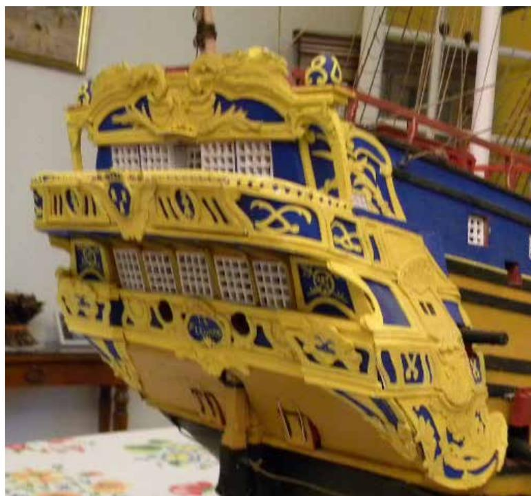
Pour en revenir à la réalisation, à part les plans fournis, j'ai été dans l'obligation de fabriquer et façonner l'ensemble des pièces nécessaires. Pour la charpente (couples et quilles), j'ai utilisé du contreplaqué, du balsa de différentes épaisseurs, du tilleul, du noisetier. Pour les mâts, du merisier provenant de meubles à la casse. Du buis que m'a procuré un client de l'agence
